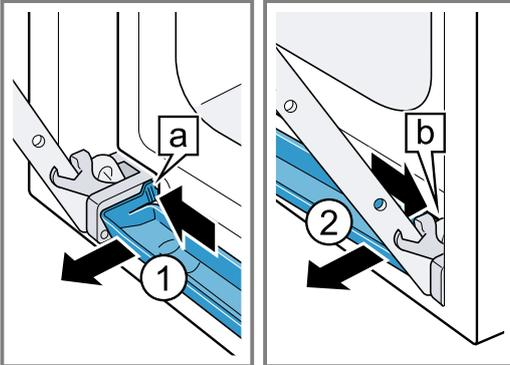
3. Inclinare leggermente in avanti la vaschetta per condensa, fino a quando i ganci di fissaggio inferiori si allentano.
