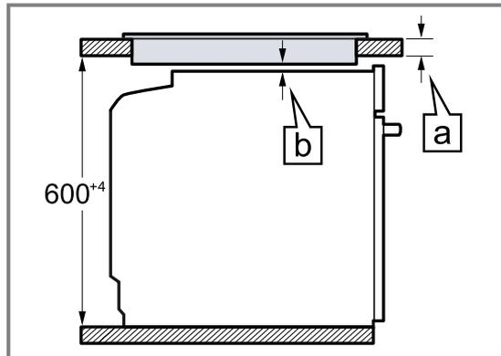
Sulla base della distanza minima necessaria  $\boxed{b}$  risulta lo spessore minimo del piano di lavoro  $\boxed{a}$ .
