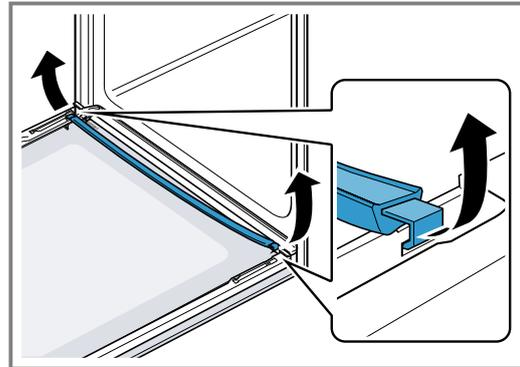
9. In caso di necessità, è possibile estrarre la barra per la condensa per la pulizia.
