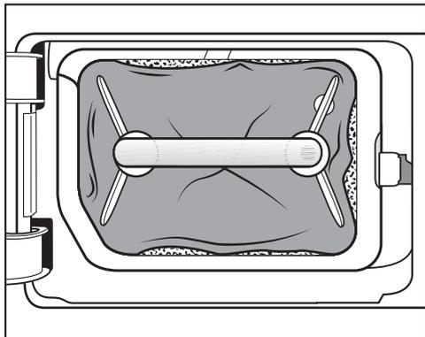
I bordi del filtro zoccolo non aderiscono e il filtro zoccolo è deformato. Per questo motivo la lanugine passa dai bordi che non aderiscono e raggiunge lo scambiatore di calore. A lungo andare lo scambiatore di calore si blocca.
