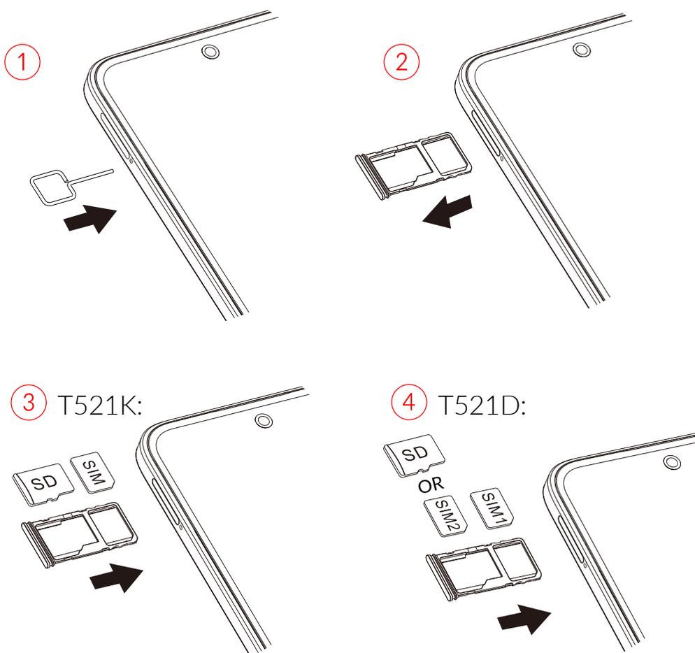
Per utilizzare il telefono bisogna inserire la scheda SIM. Non è necessario spegnere il telefono prima di inserire o rimuovere la scheda SIM, in quanto questo dispositivo supporta la sostituzione hot swap.
